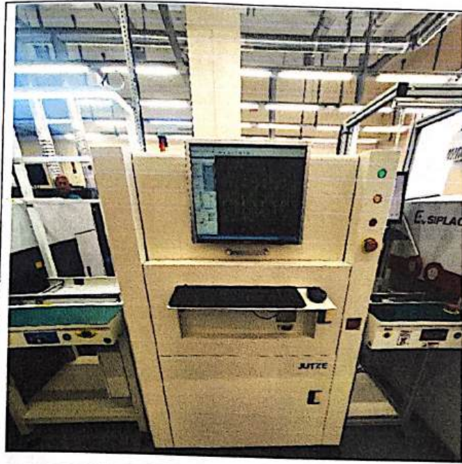
Контроль установки с использованием автоматической оптической инспекционной станции LI-2000
