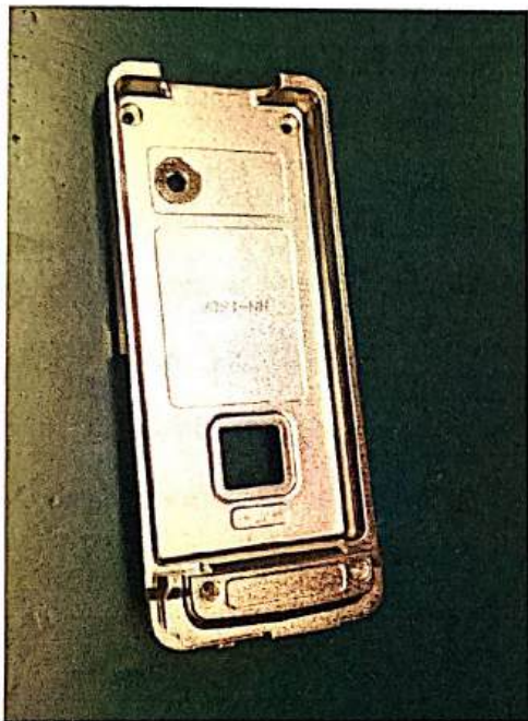
Заготовка шасси приёмопередатчика радиостанции «ЭРИКА-360» и «ЭРИКА-360.01»
