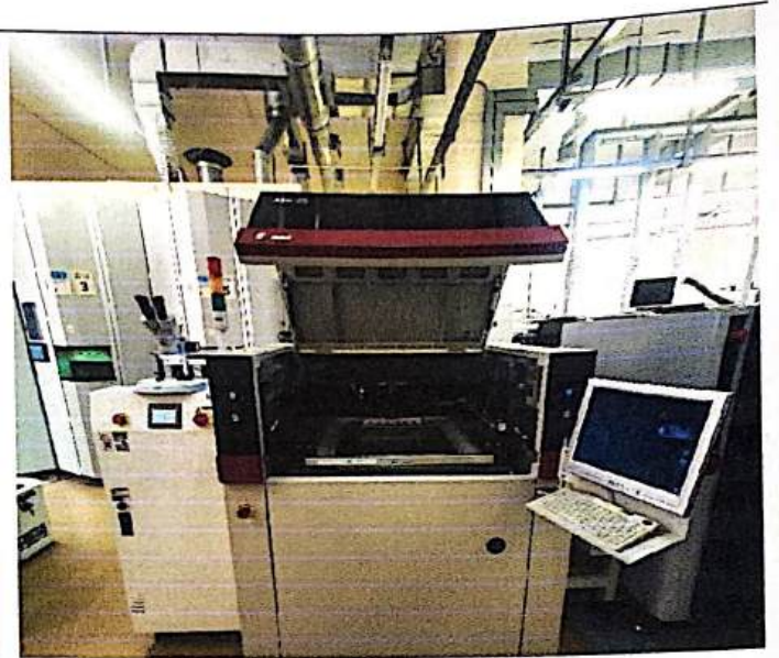
Нанесение паяльной пасты на 2-ую сторону с использованием автомата трафаретной печати ASM DEK E-series
