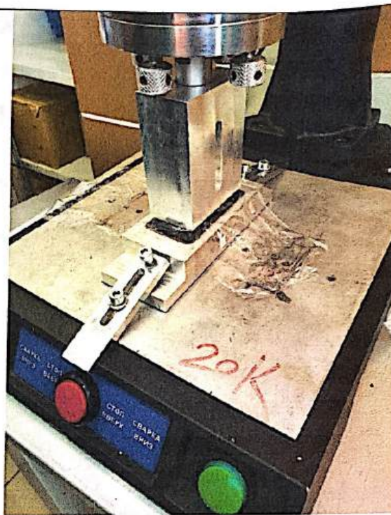
Процесс установки крышки корпуса на рабочем месте слесаря-сборщика (слева). Процесс ультразвуковой сварки крышки источника питания ИПЛ-2001 с помощью машины для ультразвуковой сварки Сварпласт АТК 1520 №111607 (справа).
