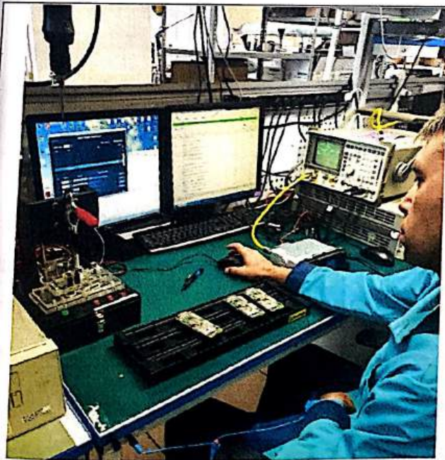
Программирование платы ПРД по инструкции ЦАВЖ.687281.033И6 с использованием компьютера с установленным Multi-Radio Flash Burn, стенда проверки носимых радиостанций ПН-01 АДЕМ.411739.001, блока питания Agilent6652A.
