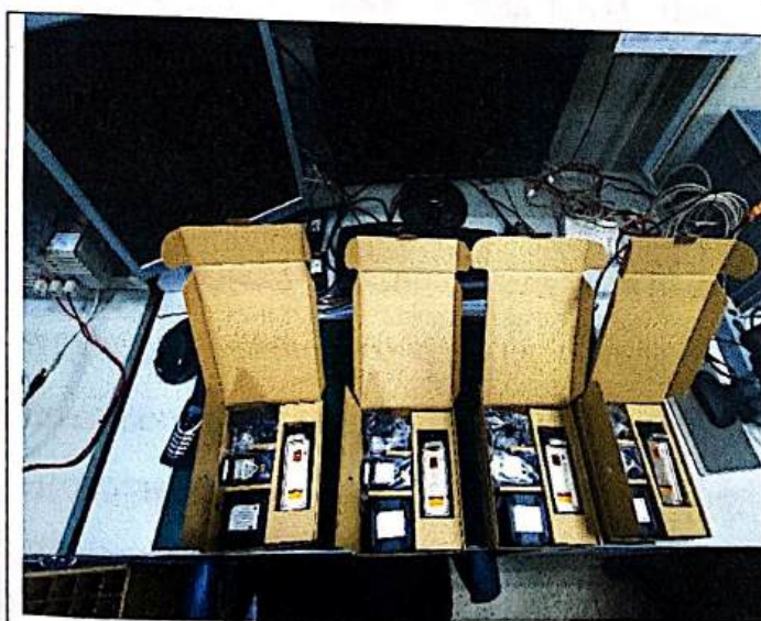
Упаковывание в потребительскую тару приемопередатчика, источника питания, антенны, устройства зарядного, руководства по эксплуатации, паспорта, скобы крепления на ремень, шнура для переноски с использованием стола комплектовщика.
