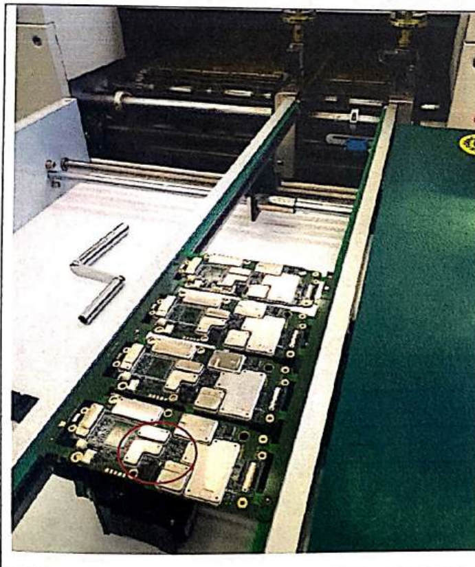
Оплавление паяльной пасты на 2-ой стороне с использованием Конвекционной печи оплавления припоя IPC-708A
