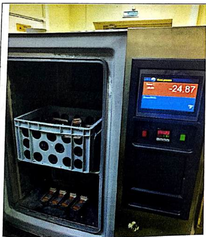
Испытания климатические на воздействие температуры пониженной с использованием Камеры климатической МНС-120ССА
