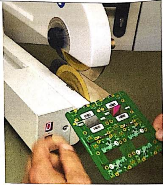
Отрезная операция с использованием установки разделения групповых заготовок «Maestro 2M».
