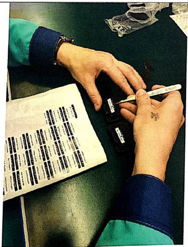
Процесс наклеивания шильдиков на рабочем месте слесаря-сборщика (слева). Процесс выходного контроля – проверка уровня напряжения на контактах и заряда источника питания ИПЛ-2001 на рабочем месте регулировщика (справа)
