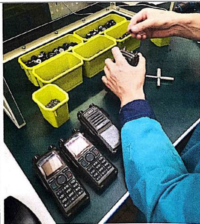
Стыкование шлейфов, крепление платы приёмопередатчика на шасси, крепление платы тналов и крепление к шасси (слева). Установка гаек и ручек регулятора громкости, селектора тналов и антенны (справа).
