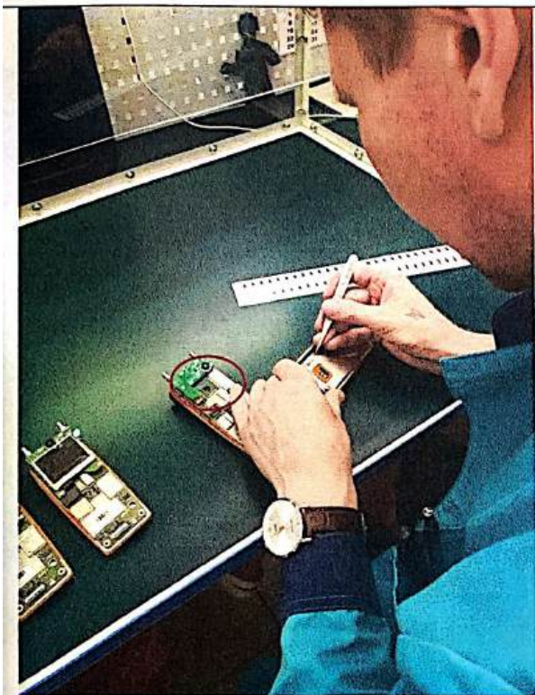
Сборка приёмопередатчика (слева), Встраивание УПР в Переднюю крышку в сборе (справа).
