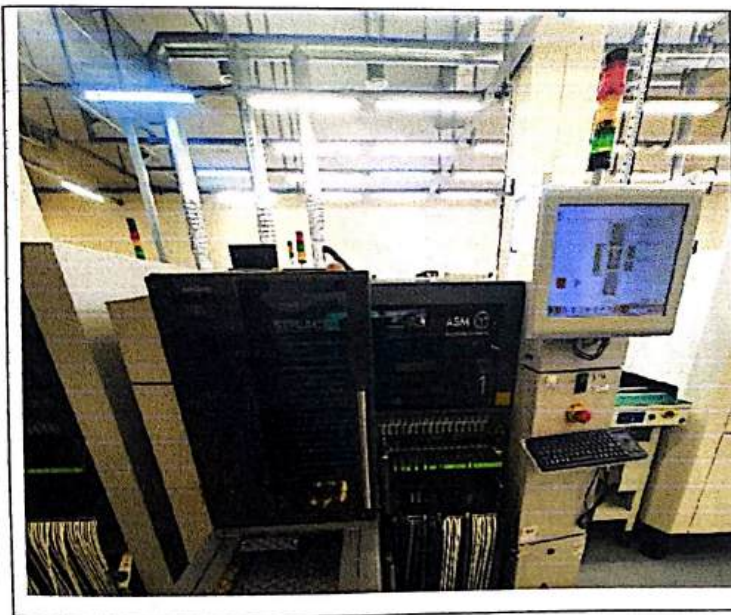
Установка компонентов на 2-ую сторону с использованием: автомат-установщик ASM SX4, автомат-установщик ASM SX2, автомат-установщик ASM Siplace E-series.
