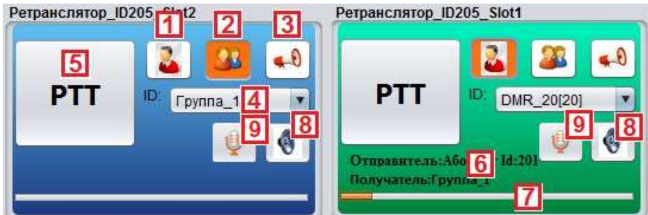
Рисунок 12.5 – Панель управления приемопередатчиком (трансивером)
